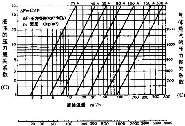
压力损失和流量(使用状态)的关系
